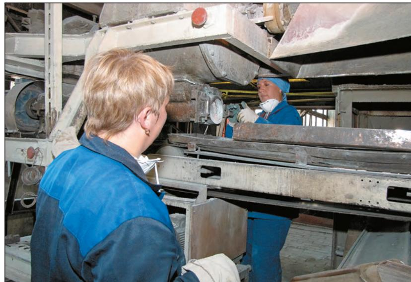
Узел формования катализаторов в форме экструдатов. Производство катализаторов такого вида повышает производительность их наработки по сравнению с выпуском катализаторов в форме таблеток и колец с помощью таблетмашин. Катализаторы-экструдаты применяются в различных реакторах.
